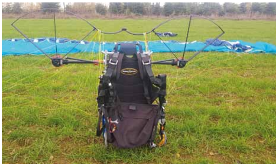
À gauche, toujours en 2017, une des premières séances de gonflage du tout premier ensemble, un ancien châssis inox base Backbone modifié.
